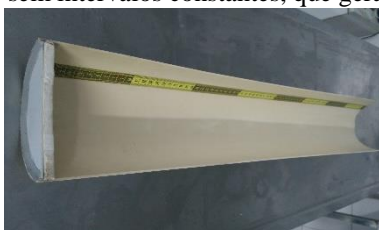
Figura 1: Ictiômetro produzido para o trabalho.
